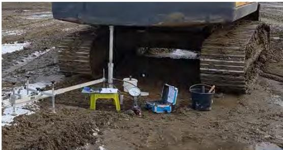
Lastplattendruckversuchen und dynamischen Fallplatten sowie durch leichte Rammsonden (DPL). Baubegleitend auch Durchführung laborphysikalischer Untersuchungen (Bestimmung Glühverluste und Wassergehalte, Kornverteilung durch Sieb-/Schlammversuche, Durchführung Proctorversuche).
